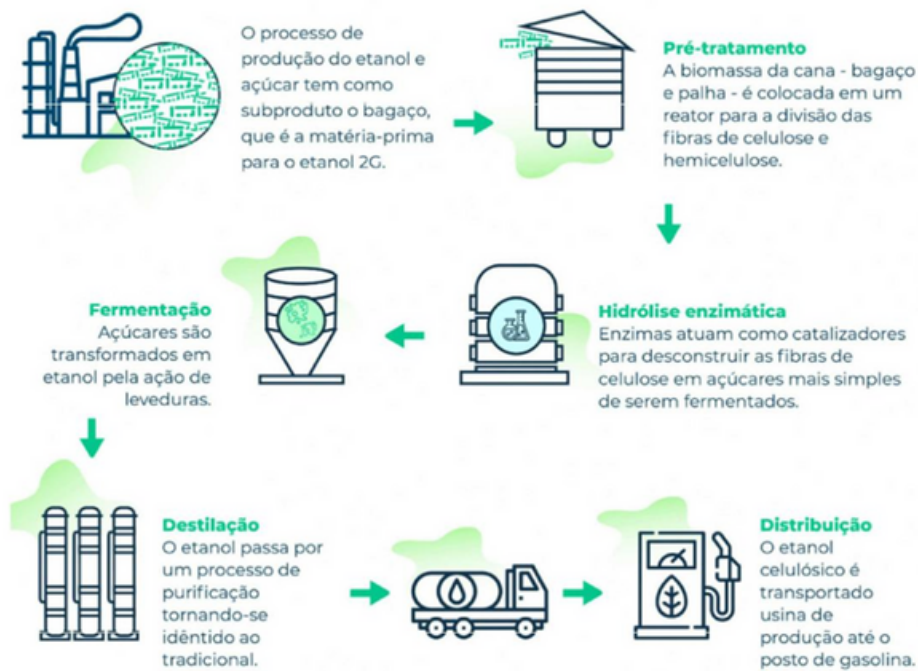
Figura 8. Processo produtivo do etanol de segunda geração. Unica (2022).
